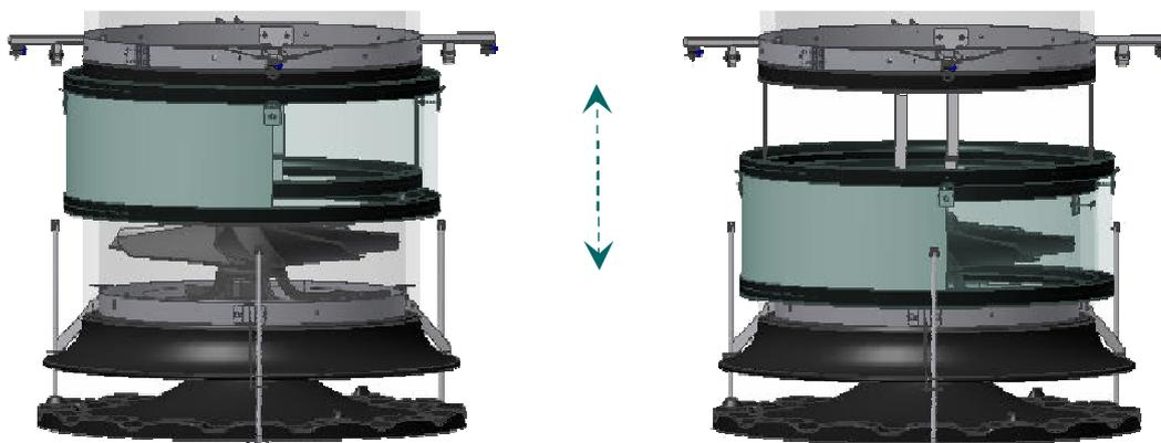
Die Menge der Umluft wird über das Verschlussrohr und den Umluftventilator geregelt. Dazu betätigt ein Linearmotor ein an das Verschlussrohr angebrachtes Zugseil und regelt somit den Öffnungsgrad des Verschlussrohres.
